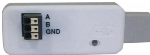
**IT** EcoECCO è un'interfaccia USB-DMX/RDM compatibile con lo standard RDM e DMX USITT 1990, EcoECCO è un dispositivo economico rispetto a ECCO, e non è optoisolato galvanicamente, quindi i dispositivi DMX sono connessi alla massa del PC. EcoECCO permette di comunicare con i dispositivi RDM tramite il software Esuite o Ecco, il collegamento avviene tramite appositi connettori a molla, i segnali sono A e B ed il riferimento di Ground
